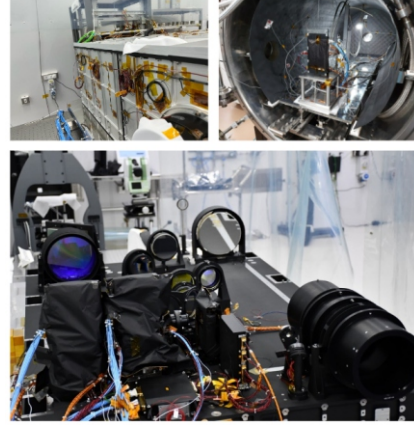
चित्र 6.1: (बाएं) टीवीएसी में वीईएलसी संसूचक अंशांकन, (दाएं) थर्मल हार्डवेयर तथा हार्नेस रूटिंग, (नीचे) क्रेस्ट एमजीके मेनन प्रयोगशाला में पेलोड के साथ एकीकरण।
