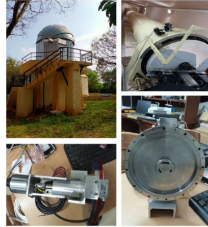
चित्र 6.2: (ऊपर बाएं ओर) क्रेस्ट में आंतरिक रूप से विकसित क्लैमशेल गुम्बद, (ऊपर दाएं ओर) सटीक रैखिक चरण पर चलने योग्य तीन कैमरा आलंबन, (नीचे बाएं और दाएं ओर) एच-अल्फ कूटलेखित्र परीक्षण प्रणाली।
