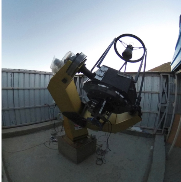
चित्र 2.48: ऊपर: हनले में नवीनीकृत 50 cm, एफ/10 आर-सी दूरबीन का छायाचित्रण।(चित्र सौजन्य: स्टैनज़िन और अन्य, प्रोक. एसपीआईई वॉल्यूम 12181, 121820ई)
